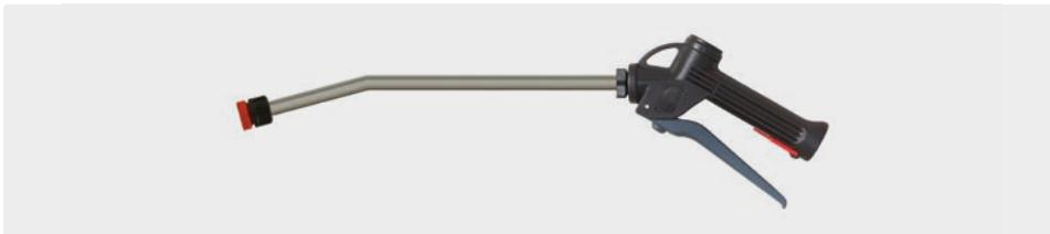
300 mm. Pistolet produit avec lance inox équipée d'un porte-buse, livré sans buse. Pistolet avec bille inox V4A / AISI 316, résistante aux agents chimiques. Max. 25 bar / 30 l/min / 50 °C
