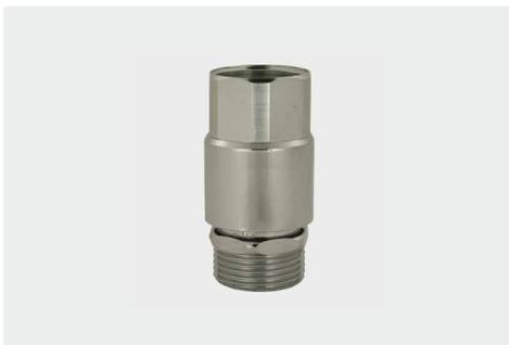
Laiton chromé. Clapet de déconnexion conforme aux normes DIN 19884 et DIN EN 171. Empêche le flux de retour (eau savonneuse) dans les canalisations d'eau potable. Prescrit pour l'alimentation directe des pompes HP sur le réseau d'eau.
