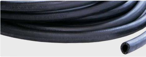
Gaine interne et externe noires. Série industrielle pour l'eau et l'air comprimé. Résistant aux frottements et aux UV. Pression de rupture > 60 bar. Max. 20 bar. -10 °C - +60 °C
