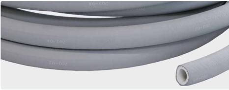
Gaine externe NBR grise. Gaine interne blanche qualité alimentaire, convient au transfert des fluides chauds ou froids. Résistant aux graisses animales. Pression de rupture > 60 bar. Max. 20 bar. -20 °C - +100 °C
