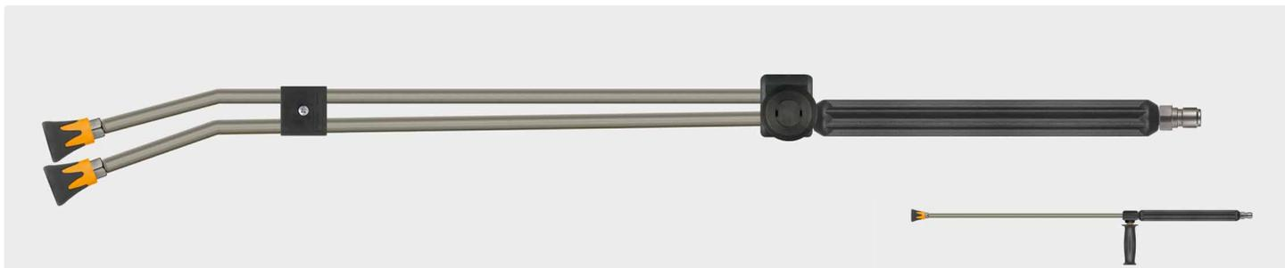
Coupleur ST-3100. Double-lance surmoulée 300 mm en inox, robinet latéral ST-54 et porte-buses ST-10, livrée avec buse basse-pression. Max. 310 bar / 150 °C
