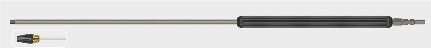
Coupleur KW. Lance surmoulée 400 mm en inox et tube 1/4" M pour montage rotabuse. Livrée sans rotabuse. Max. 400 bar / 150 °C
