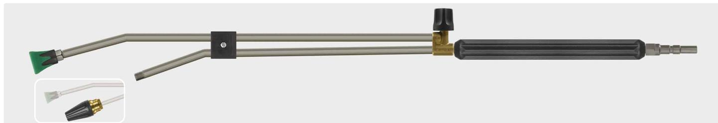
Coupleur KW. Double-lance surmoulée 300 mm en inox, robinet vertical ST-53, porte-buse ST-10, livrée avec buse basse-pression, tube 1/4" M pour montage rotabuse. Livrée sans rotabuse. Max. 250 bar / 150 °C
