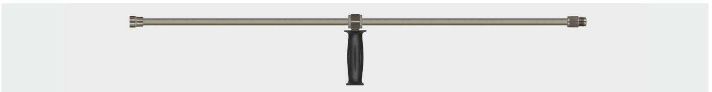
1/2" M. Lances avec poignée latérale et porte-buse 1/4" F NPT en inox, livrées sans buse haute-pression. Max. 600 bar / 150 °C
