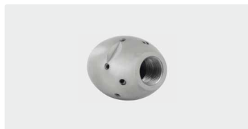
1/4"F. 6x 75° 3x 30° +1x 0°. 25-70 l/min. Pour (R) 75-150 mm. Ø Extérieur 30 mm. [B] 223 g.
