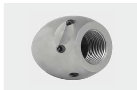
3/4"F. 6x 75° +1x 0°. 30-100 l/min. Pour (R) 120-250 mm. Ø Extérieur 50 mm. [B] 567 g.
