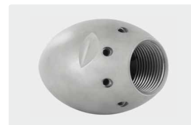
1"F. 8x 75° +1x 0°. 100-250 l/min. Pour (R) 150-300 mm. Ø Extérieur 62 mm. [B] 1.265 g.
