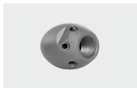
1/4"F. 6x 75° +1x 0°. 20-50 l/min. Pour (R) 50-100 mm. Ø Extérieur 30 mm. [B] 127 g.
