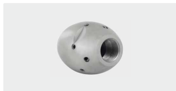
3/8"F. 6x 75° 3x 30° +1x 0°. 30-100 l/min. Pour (R) 100-200 mm. Ø Extérieur 35 mm. [B] 314 g.
