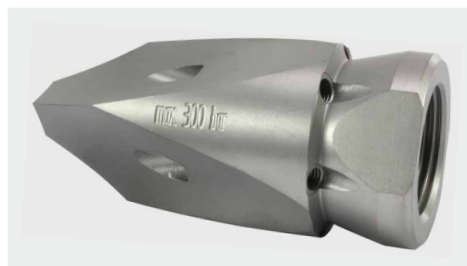
300 bar. 3/4" F. □ 80 mm, ∅ = 38 mm, Ⓢ 0,29 kg. Pour conduites > 80 mm. Jets avant et latéraux avec inserts en inox durci
