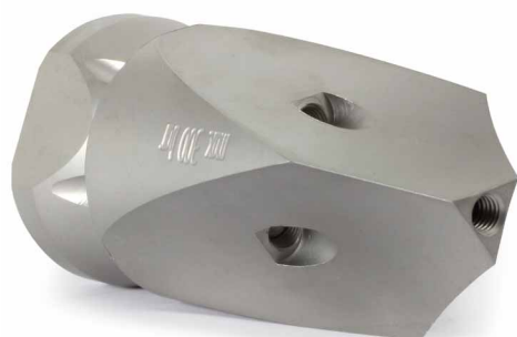
350 bar. 1/4" F. □ 50 mm, ∅ = 25 mm, Ⓢ 0,13 kg. Pour conduites > 30 mm. Jets latéraux perçage à 0,5 mm
