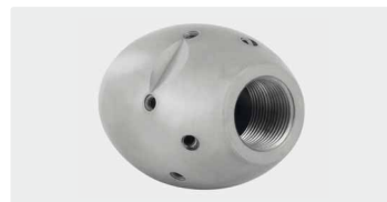
3/4"F. 6x 75° 3x 30° +1x 0°. 100-250 l/min. Pour (R) 150-300 mm. Ø Extérieur 50 mm. [B] 1.367 g.
