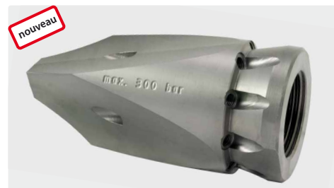
300 bar. 1" F. □ 100 mm, ∅ = 50 mm, Ⓢ 0,64 kg. Pour conduites > 100 mm. Jets avant et latéraux avec inserts en inox durci
