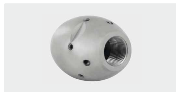
1/2"F. 6x 75° 3x 30° +1x 0°. 80-140 l/min. Pour (R) 120-250 mm. Ø Extérieur 40 mm. [B] 630 g.
