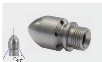
1/2" M BSP. Ø extérieur 30 mm. 6 jets rétroactifs, avec jet frontal
