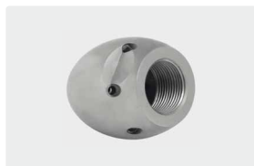
1/2"F. 6x 75° +1x 0°. 30-100 l/min. Pour (R) 100-200 mm. Ø Extérieur 40 mm. [B] 281 g.
