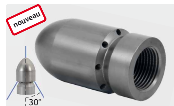
1" F. Ø extérieur 48 mm. 8 jets rétroactifs, avec jet frontal
